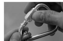
Remarque : pour un bon fonctionnement, le côté court du mousqueton doit rester inséré dans l'ouverture.
